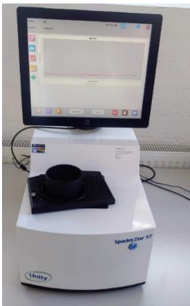
Obrázek 1 Laboratoř INTEKO - přístroj NIRS
